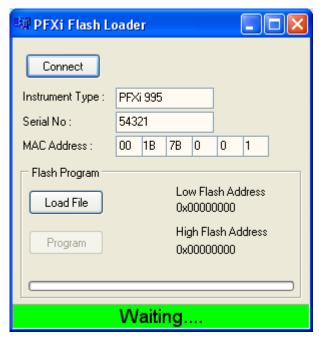
Klicken Sie auf die Schaltfläche 'Load File', um zu der neuen Flash-Datei zu navigieren ("PFXi\_100xx.flash"). Es dauert einige Sekunden, bis die Datei geladen wird. Sobald die Datei korrekt geladen worden ist, wird die 'Programm'-Schaltfläche aktiviert und die Adresse der Firmware wird (zur Informationszwecken) angezeigt:
