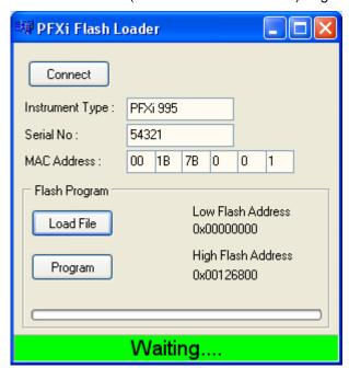
Klicken Sie auf die 'Programm'-Schaltfläche. Der Download der neuen Firmware startet; sie wird im Instrument programmiert.
