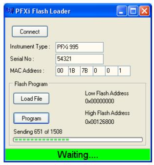
Nach Abschluss der Programmierung, wird am LCD 'Instrument Update erfolgreich. Neustart' angezeigt —. Schalten Sie das Gerät aus und wieder ein. Vergewissern Sie sich am Splash-Screen, dass die Software-Version korrekt ist (sie muss mit der Version im Dateinamen übereinstimmen).
